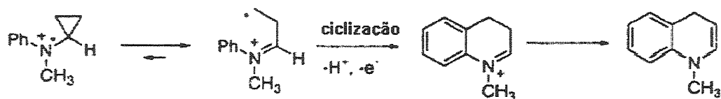
Esquema 62 – Proposta do mecanismo da ciclicação por "Horseradish peroxidase". 138
