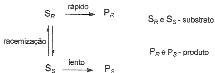
Esquema 48 – Esquema da resolução cinética dinâmica (RCD).
