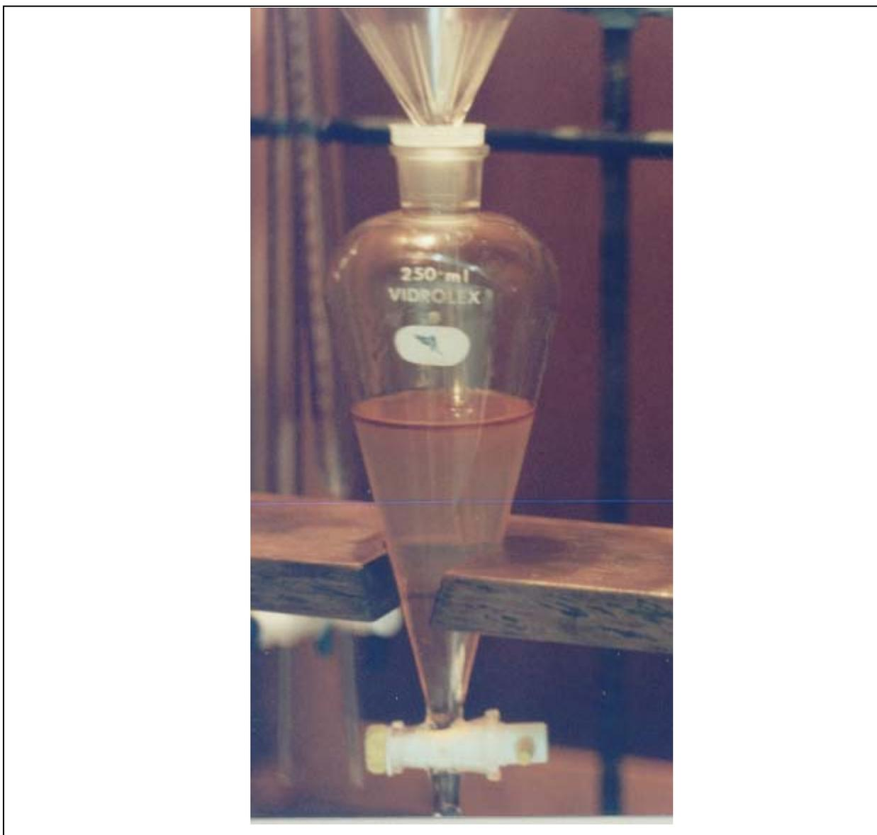
**Figura 4:** Sistema de extração empregado após o rompimento das fases e a presença da fase orgânica de MIC, avermelhada, indicando a complexação do Fe(III) com TTA.
