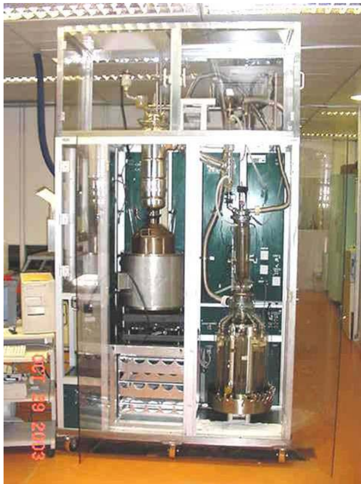
Figura 10. Equipamento para destilação a vácuo para obtenção da curva PEV
