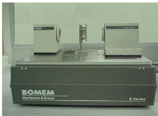
Figura 20. Instrumento 2 (com detalhe da cela de transmitância)
