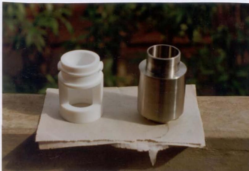
Figura 13: Fotografia das peças de PTFE e aço inox
