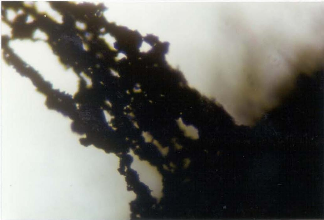
Figura 40: PANI/Nujol ampliada 10 x a  $\sim 1.000$  V/mm, em outra região da lâmina.
