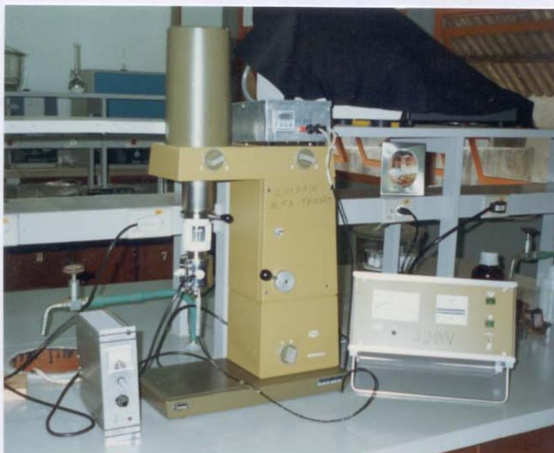
Figura 14: Fotografia do viscosímetro.
