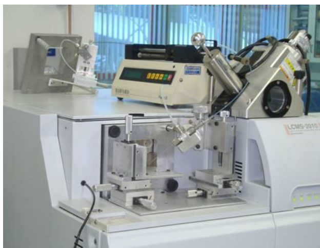
Figura 13. Fonte de ionização EASI acoplada ao analisador monoquadrupolo utilizado para as análises de biodiesel.
