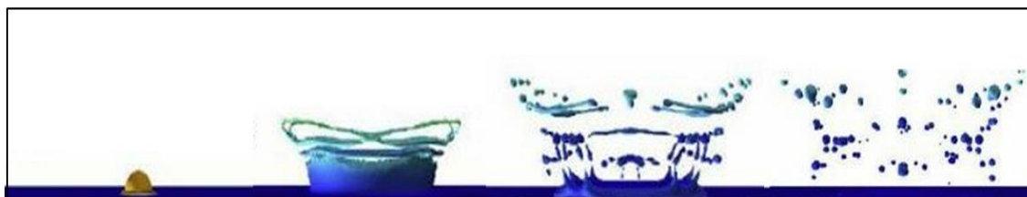
Figura 8. Incidência das gotículas sobre a superfície e a formação das gotículas secundárias em uma sequência de tempo. (adap. de Costa e Cooks, 2008).
