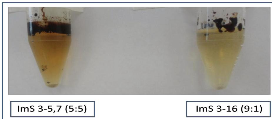
Figura IV.37: Quantidade de óleo removida de carbonato após 72 horas.
