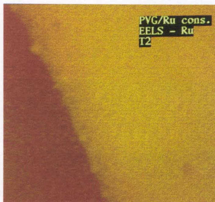
Figura 41 - Imagem EELS do Ru ( M_{4,5} ) para a amostra PVG/Ru consolidado.
