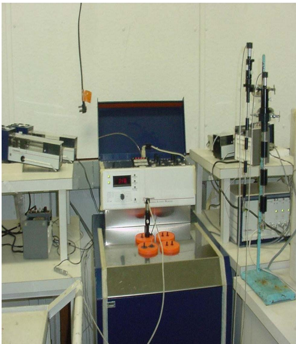
Figura 12 – Microcalorímetro Isotérmico de condução de calor LKB 2277.
