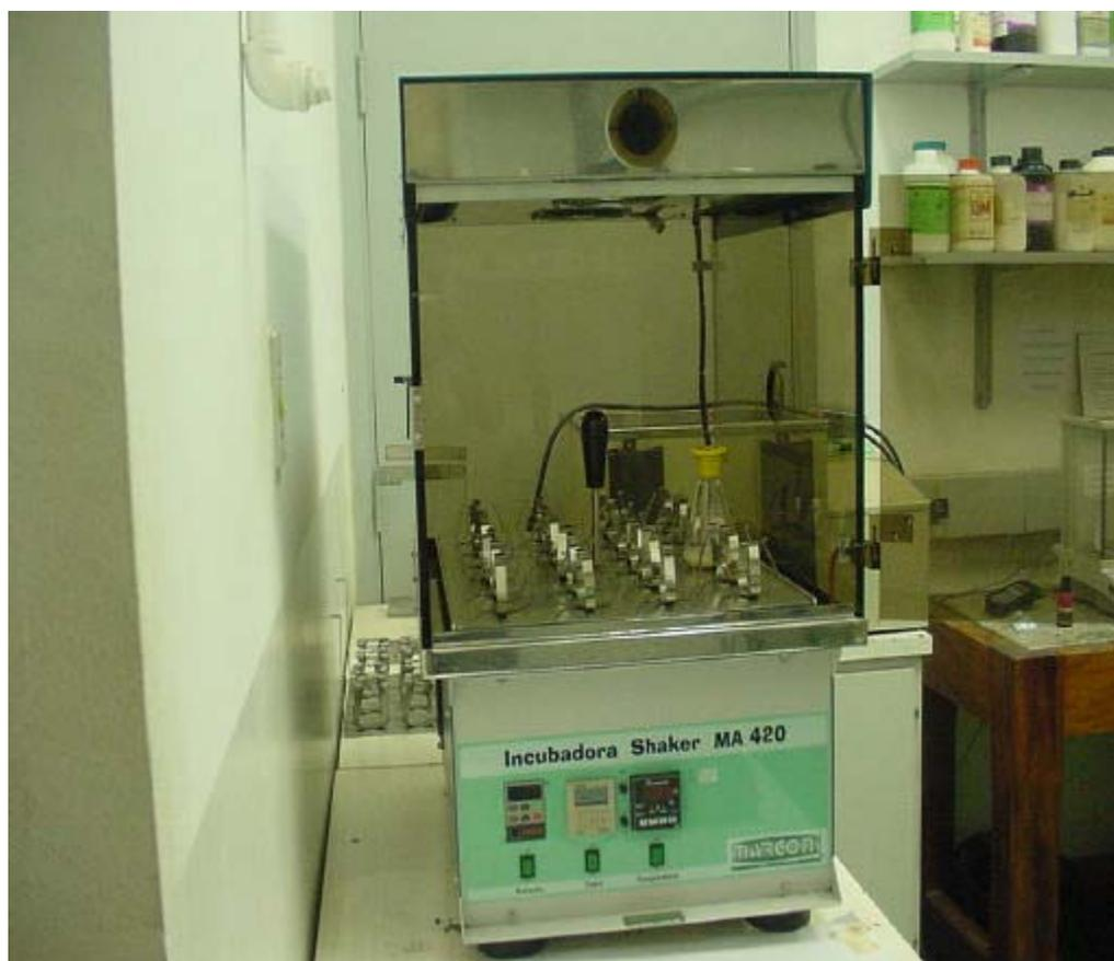
Figura 11 – Agitador com banho termostatizado.
