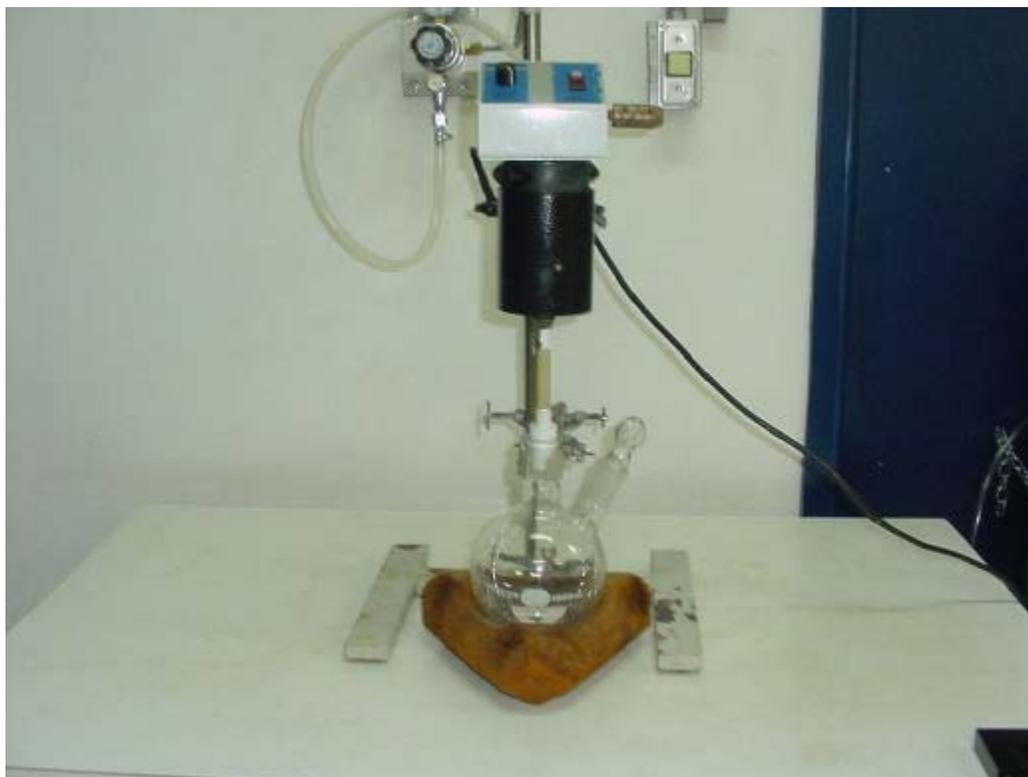
Figura 8 - Sistema montado para a realização N,O-succinação.
