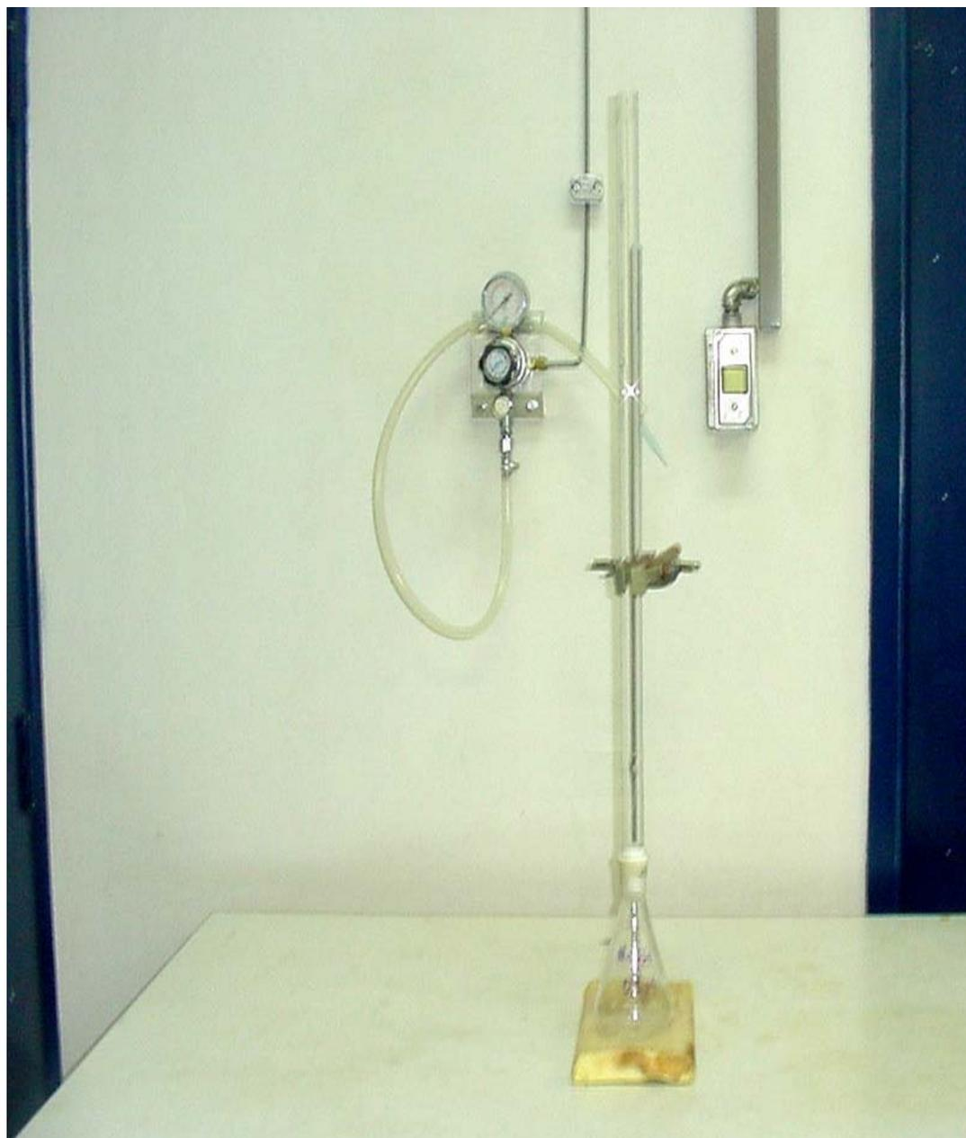
Figura 9 – Coluna de vidro com 80 cm de altura para confecção da esfera do tipo I.
