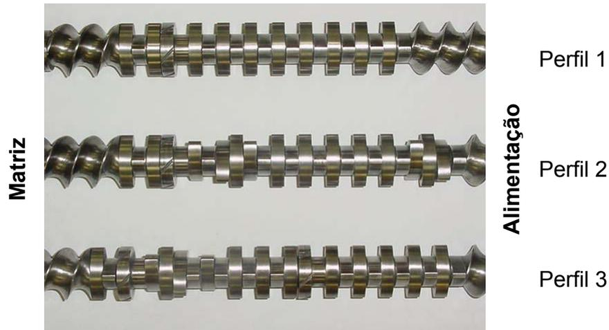
**Figura 4.1** – Configurações das roscas empregadas para a obtenção dos nanocompósitos na extrusora dupla rosca. O fluxo do fundido é da direita para esquerda.
