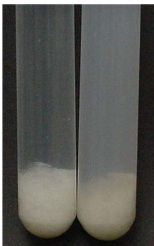
figura 20- Comparação entre: (**esquerda**)-sobrenadante de crisotila **L** (100 mg) dispersa em 10 mL de água destilada; (**direita**)-sobrenadante de crisotila **L** (100 mg) dispersa em 10 mL de solução aquosa de silicato de sódio(7,5 g/L).
