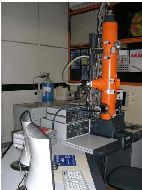
**Figura 41.** Microscópio eletrônico de transmissão.
