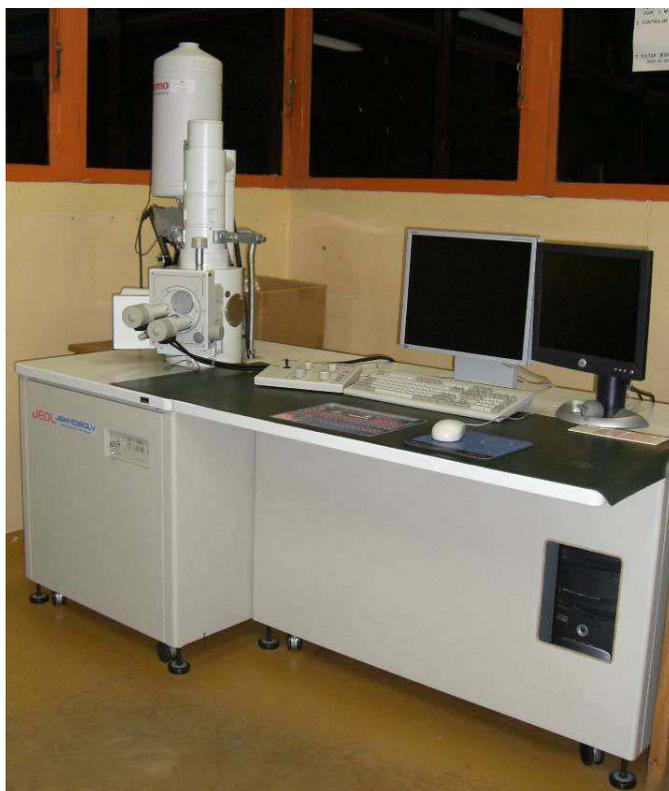
**Figura 40.** Microscópio eletrônico de varredura JEOL LV-JSM 6360 utilizado para obtenção das imagens apresentadas nesta tese.
