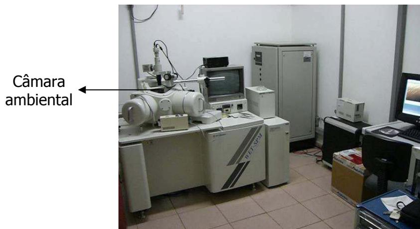
**Figura 39.** Microscópio de força atômica modelo WET- SPM Shimadzu. O microscópio fica dentro de uma câmara ambiental.
