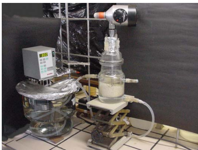
Figura 21. Foto do reator utilizado para a bioedução de 1a em escala multigrama.
