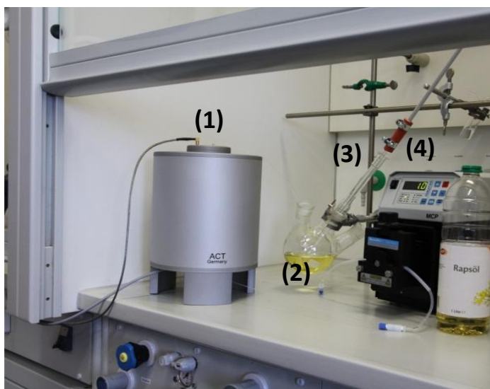
Figura 3.6 – Sistema empregado para o monitoramento da reação de transesterificação empregando um espectrômetro de baixo campo KEA 2 . (1) Magneto permanente, no interior do qual encontra-se a célula de medida. (2) Reator montado a partir de um balão de três bocas, contendo um (3) agitador mecânico, um termômetro digital e tubos de Teflon para o transporte da mistura reacional, com auxílio de uma (4) bomba peristáltica, para o interior do magneto.
