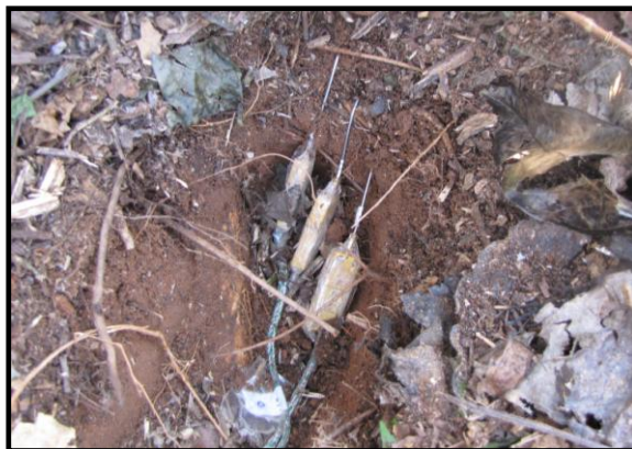
Figura 5. Termopares dispostos em diferentes profundidades do solo para registrar perfis de temperatura durante a queimada.
