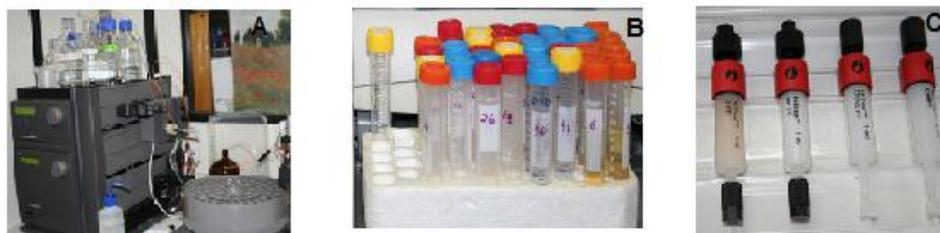
**Figura 60.** A: equipamento FPLC. B: frações coletas após a purificação. C: colunas de troca aniônica e troca catiônica.
