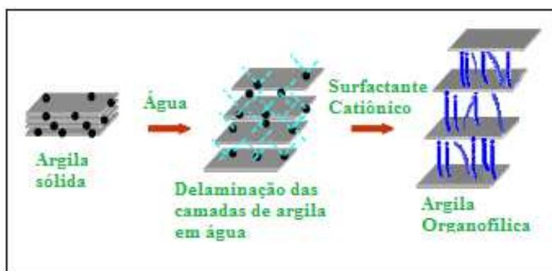
Figura 2 – Esquema da troca iônica em argila para a síntese de organoargilas.
