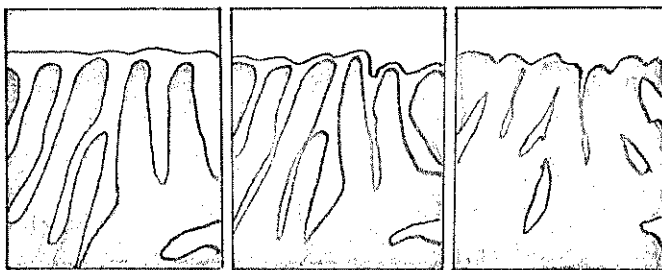
Figura 31. Representação esquemática da contração de uma estrutura porosa (vista em corte) provocada pela remoção progressiva de água.
