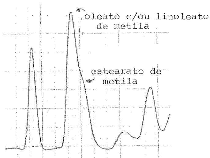
fig. 11 - Cromatograma do estearato e oleato(e/ou linoleato) de metila com programação multilinear de temperatura
