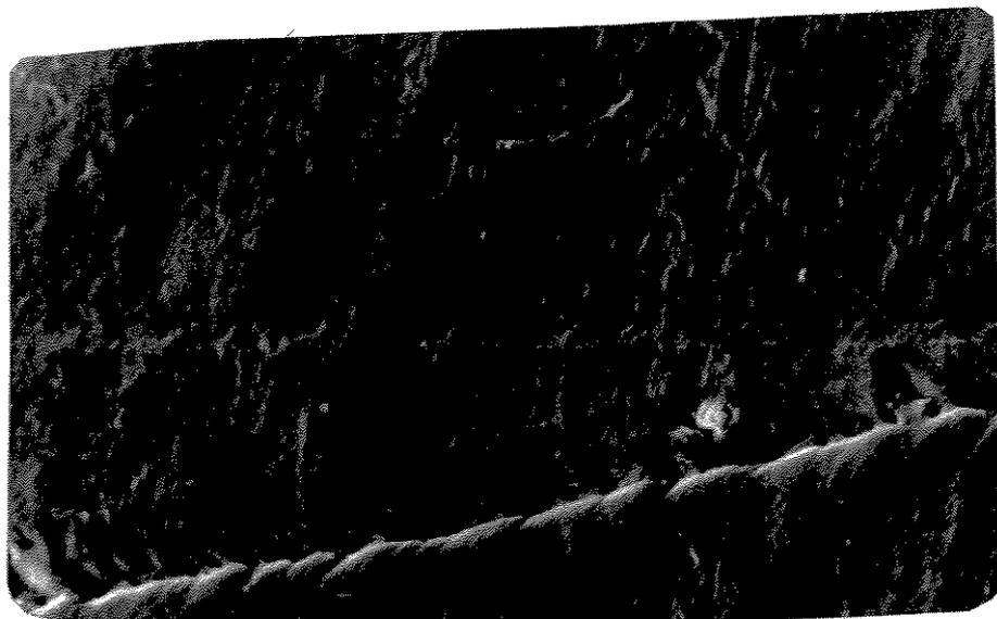
Figura 16a - Micrografia eletrônica de varredura de superfície original de PEBD. Aumenta 4000 vezes.
