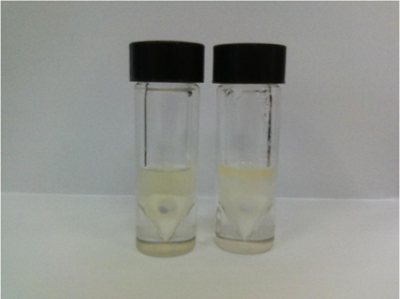
Figura 7: Foto ilustrando a diferença visual entre amostra de toucinho saponificada sem neutralização ( esquerda) e amostra saponificada e neutralizada (direita).
