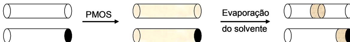
**Figura 12.** Ilustração dos experimentos realizados com capilares de vidro e soluções de PMOS.
