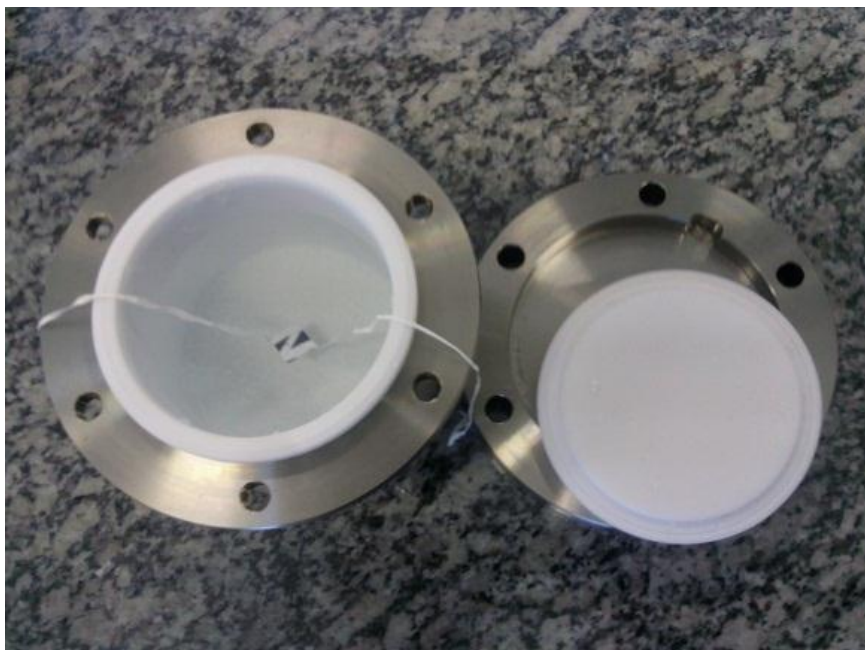
Figura 10: Autoclave utilizada para a síntese dos nanobastões via síntese hidrotermal.
