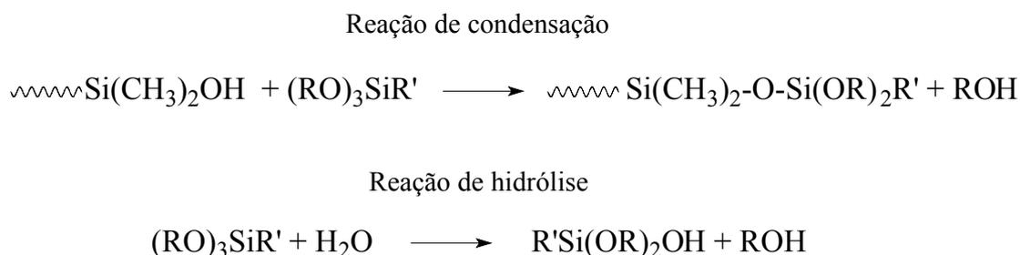
Figura 4. Representação das reações de condensação e hidrólise.
