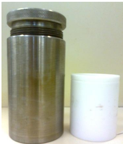
Figura 18. Autoclave de aço inoxidável e copo de teflon.
