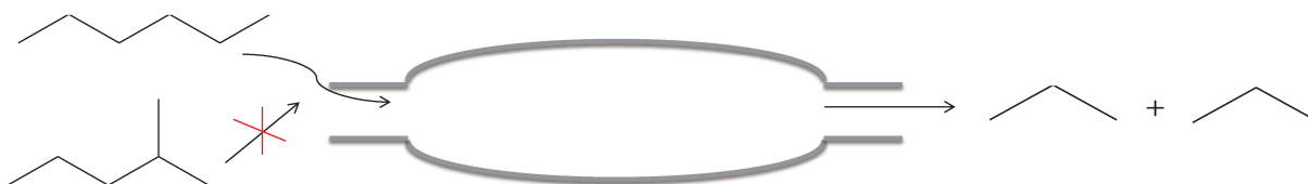
Figura 15. Representação esquemática de seletividade de forma a moléculas reagentes. (87)
