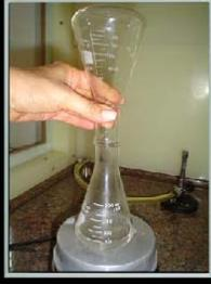
Para coletar o gás amônia, coloque pequena quantidade de hidróxido de amônio concentrado em um erlenmeyer, emborque sobre ele outro erlenmeyer e aqueça até a solução entrar em ebulição.
