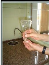
Retire o erlenmeyer mantendo-o de boca virada para baixo e tampe-o com uma rolha furada e adaptada a um tubo de vidro.
