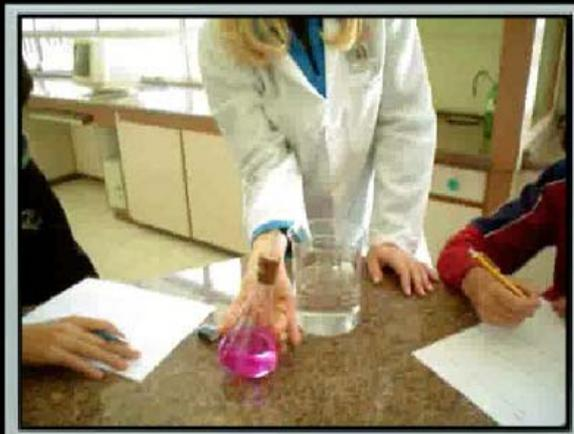
**A amônia dissolve-se na água produzindo um vácuo parcial no erlenmeyer. Devido à diferença entre a pressão externa e a pressão no interior do erlenmeyer, a água do béquer sobe pelo tubo jorrando como um chafariz. O hidróxido de amônio produzido, em contato com o indicador fenolftaleína, torna o líquido rosa.**
