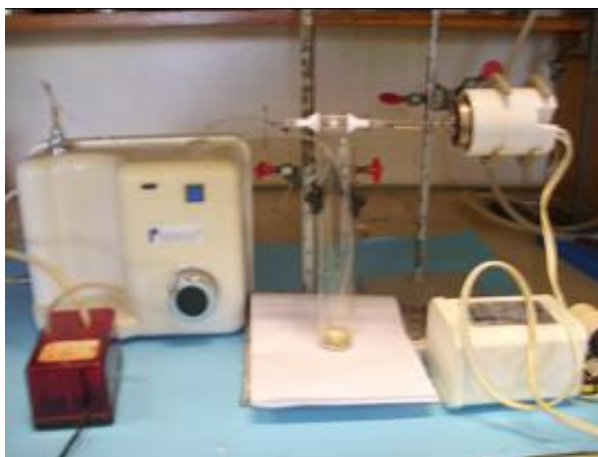
Figura 4.7. Sistema empregado para a ozonização das amostras e irradiação UV.
