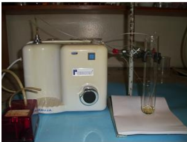
Figura 4.6. Sistema empregado para a ozonização das amostras.
