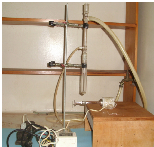
Figura 4.8. Sistema utilizado para irradiação UV com tubo de quartzo acoplado ao condensador.
