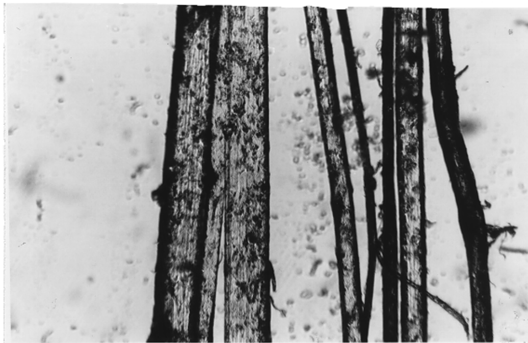
Figura 37: Fotografia da fibra de polipropileno, após inclusão no concreto, obtida em microscópio ótico metalográfico de base invertida marca Carl Zeiss, modelo Metaval HD. Aumento de 50 vezes.
