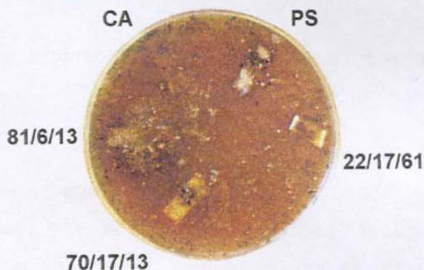
*Figura 39: Teste de biodegradação para os filmes porosos de CA e PS puros e CA/VTAS/PS em diferentes composições, 1 ano após contato com o fungo *T. harzianum*.*
