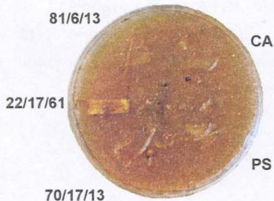
Figura 36: Teste de biodegradação para os filmes densos de CA e PS puros e CA/VTAS/PS em diferentes composições, 1 ano após contato com o fungo *T. harzianum*.
