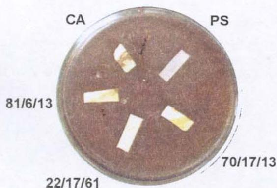
Figura 38: Teste de biodegradação para os filmes porosos de CA e PS puros e CA/VTAS/PS em diferentes composições, 30 dias após contato com o fungo *T. harzianum*.
