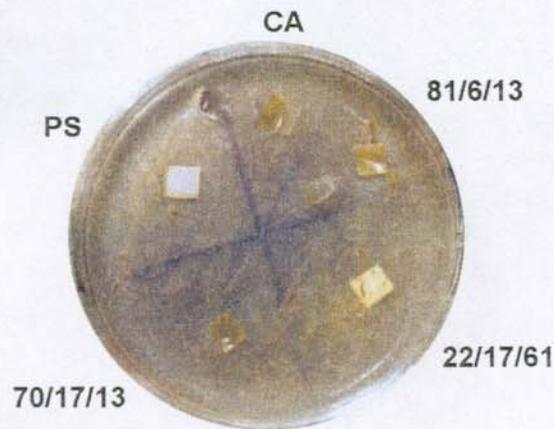
Figura 35: Teste de biodegradação para os filmes densos de CA e PS puros e CA/VTAS/PS em diferentes composições, 30 dias após contato com o fungo *T. harzianum*.
