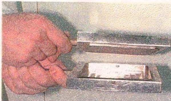
Figura 6. Fotografia do molde utilizado na preparação dos filmes poliméricos
