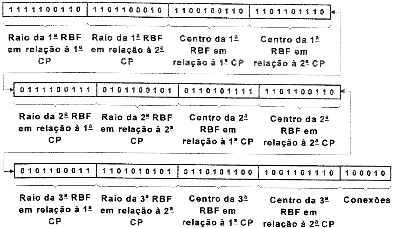
Figura 3.5 – Exemplo da codificação de um indivíduo para a otimização simultânea dos parâmetros das RBF's com precisão de 10 bits e das conexões de uma RBFN com 3 RBF's e duas variáveis de entrada (CP) por AG.
