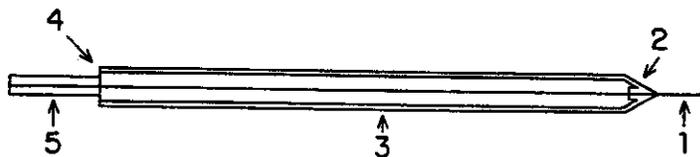
**Figura 3.8** - Diagrama esquemático da preparação do microeletrodo: 1- fibras de carbono; 2- junção da fibra de carbono com o fio condutor; 3- tubo de polietileno, preenchido com pasta de carbono condutora; 4- resina epóxi; 5- contato elétrico.
