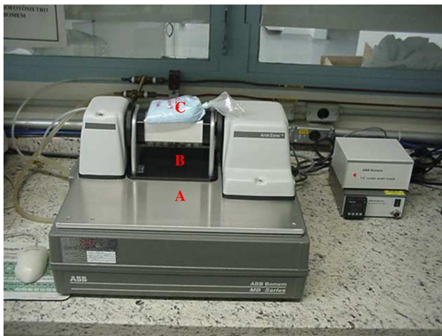
**Figura 12:** Equipamento utilizado na obtenção dos espectros com uma amostra de detergente em pó sobre o acessório de medida de refletância. (A) espectrofotômetro Bomem MB-160; (B) acessório para medidas de refletância; (C) amostra de detergente em pó em embalagem de filme de polietileno.
