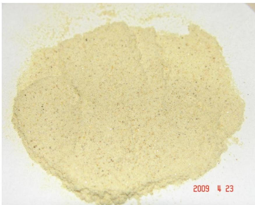
**Figura 12.** Amostra do fármaco Macrodantina®, após cuidadosa trituração em almofariz. Na fotografia podem ser vistos, dispersos no medicamento, resíduos de materiais escuros usados para a formação dos macrocristais da preparação farmacêutica.
