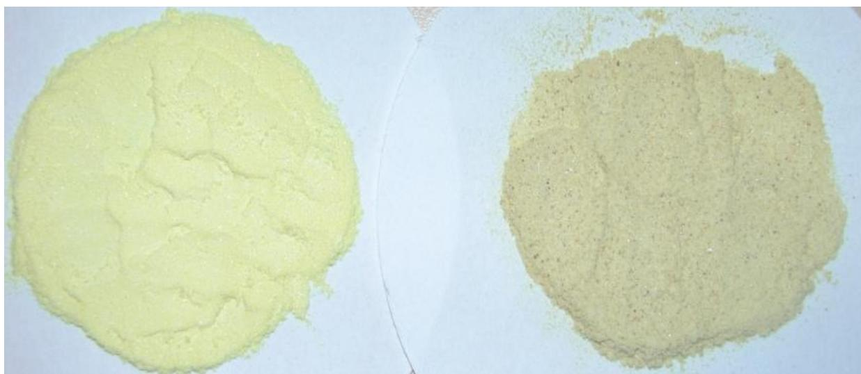
**Figura 22.** Diferença dos aspectos e da coloração da mistura preparada a partir do analito puro (esquerda) com concentração de  $272,6 \text{ mg g}^{-1}$  e do fármaco comercial (direita) com concentração aparente de nitrofurantoína da ordem de  $274 \pm 1 \text{ mg g}^{-1}$ .
