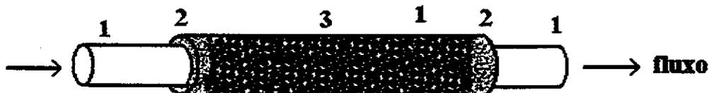
**Figura 7.2.** Diagrama esquemático do reator enzimático empregando enzima imobilizada em pérolas de vidro. 1-tubo de "Tygon®"; 2-lã de vidro; 3-pérolas de vidro com a enzima imobilizada.
