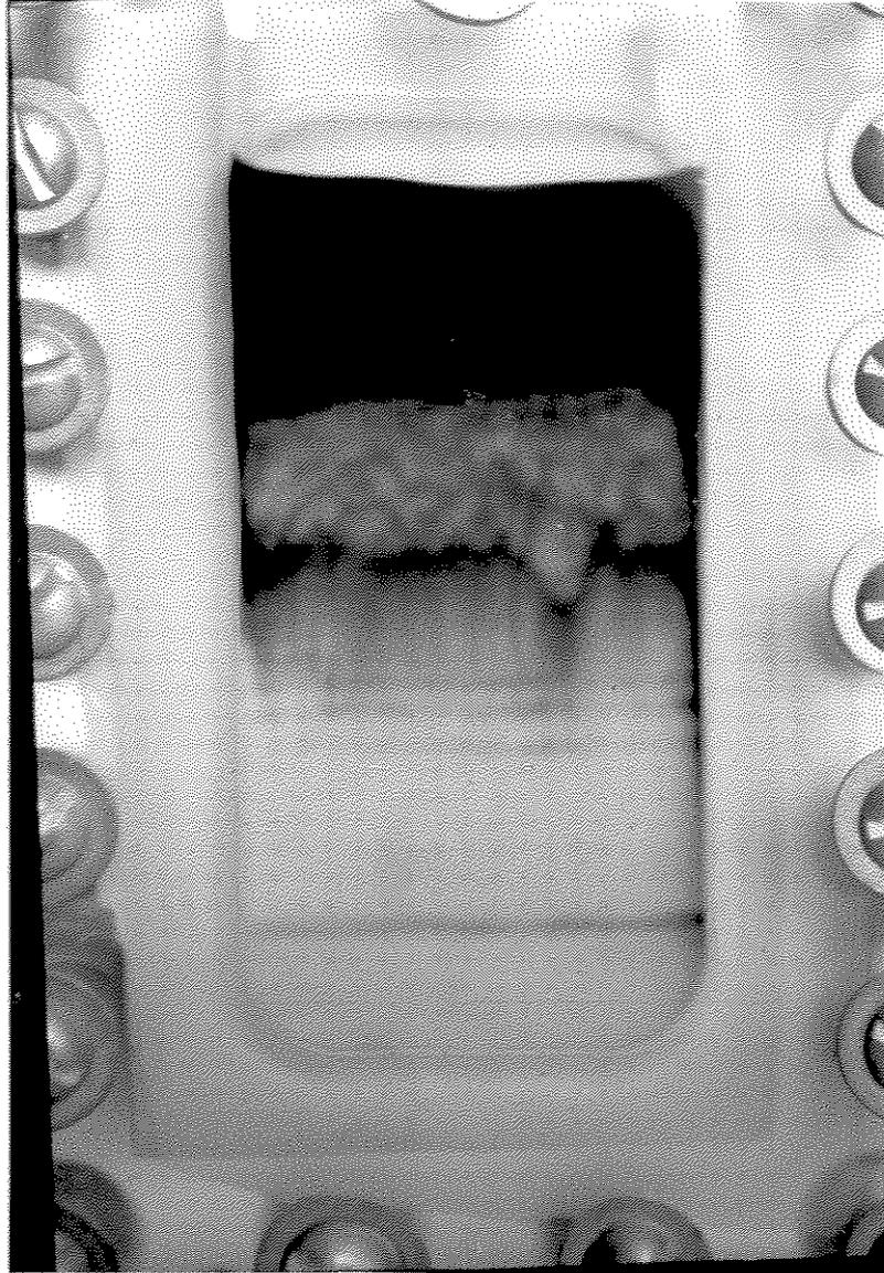
Figura 3.14: Foto da cela de osmossedimentação do experimento 7 após cinco minutos de centrifugação.
