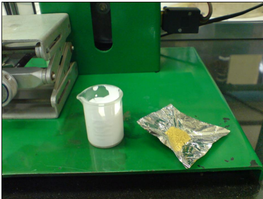
Figura 47. Tinta comercial à base de água e vanadato de prata nanoestruturado (Amostra P6P) utilizada como aditivo antibacteriano.
