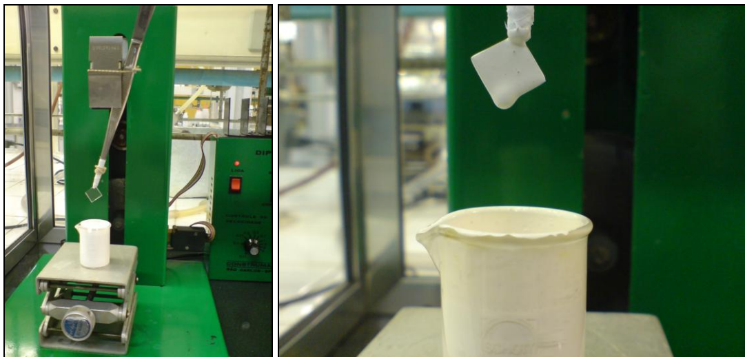
Figura 48. Equipamento utilizado para realizar as imersões das placas de vidro à tinta. Todos os materiais utilizados, incluindo a caixa plástica de proteção do equipamento foram desinfetados com álcool 70%.
