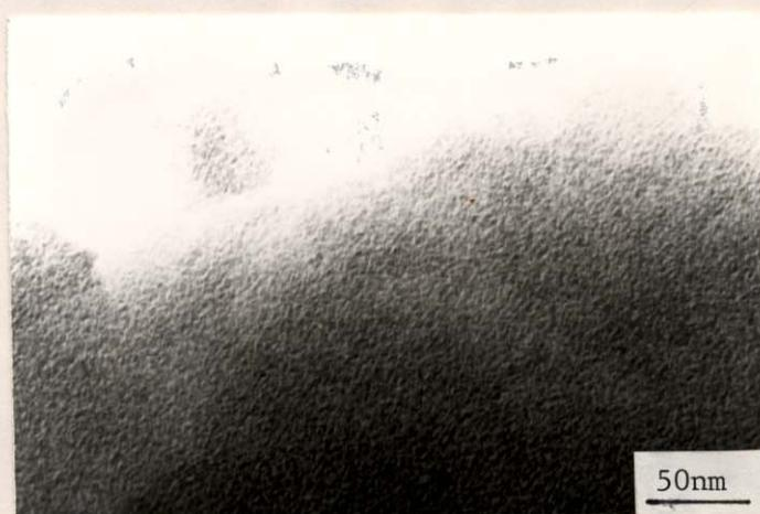
**Figura 16.** Micrografias por MET do material cerâmico 80,0%SiC; 20,0%C (derivado do P<sub>4</sub>). Em aumento de 140.000x.
