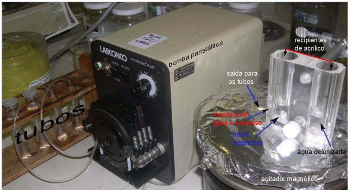
**Figura 3.3.** Equipamentos utilizados para a preparação de gradiente de densidade
