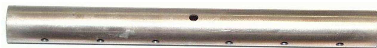
**Figura 4:** Imagem do tubo metálico indicando os furos na parte inferior e o de inserção do capilar cerâmico na parte superior.
