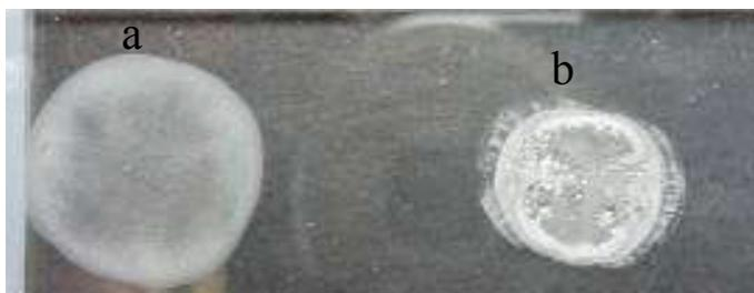
**Figura 4.3.** Filmes obtidos após a evaporação do solvente a partir de soluções em acetona contendo 20% de NaI ( $m_{\text{NaI}}/m_{\text{polimero}}$ ) em matriz polimérica de (a) PEO e (b) PVdF-HFP.
