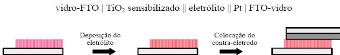
**Figura 3.5.** Esquema ilustrativo das etapas da montagem da célula solar de TiO<sub>2</sub>/corante.
