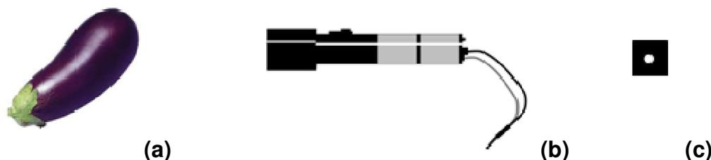
**Figura 33.** Esquema para medidas de reflectância difusa: (a) amostra de berinjela, (b) acessório de reflectância e (c) orifício de saída e entrada de luz do dispositivo.
