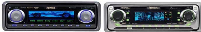
Figura 2: CD-player DEH-P9350 e DEH-P640 da Pioneer Electronics ® , cujos pixels são feitos de materiais orgânicos eletroluminescentes [10].
