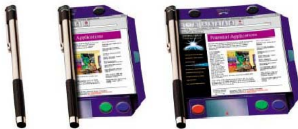
Figura 1: Protótipo de um FOLED (Flexible Organic Light Emitting Diode) da Universal Display Corp. – visor flexível contido em uma caneta [9].
