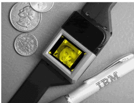
Figura 3: Relógio de pulso de OLED de alta definição desenvolvido pela IBM® e eMagic Corp. ® utilizando a tecnologia do silício [14].
