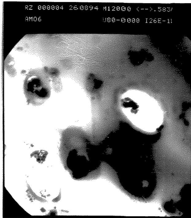
**Figura 2.15-** Microscopia eletrônica de transmissão de semi-IPN de PPI/EPDM preparados a partir de matrizes contendo inicialmente 33 % de  $\text{CuCl}_2$  ( $< 105 \mu\text{m}$ ) e 0,8 % de peróxido de dicumila. 24 h de polimerização. A barra representa a escala em  $\mu\text{m}$ .
