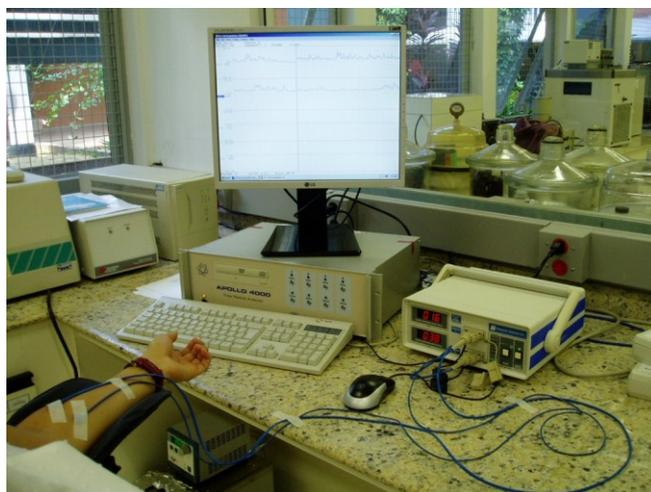
**Figura 25.** Foto ilustrativa da infra-estrutura disponível no IQ/Unicamp, para a execução das medidas de vasodilatação na pele de voluntários. Sistema de medição “Transonic Systems Inc.” de dois canais, que permite o monitoramento simultâneo da região tratada (PVA com GSNO) e de uma região controle (eletrodo na pele do voluntário).
