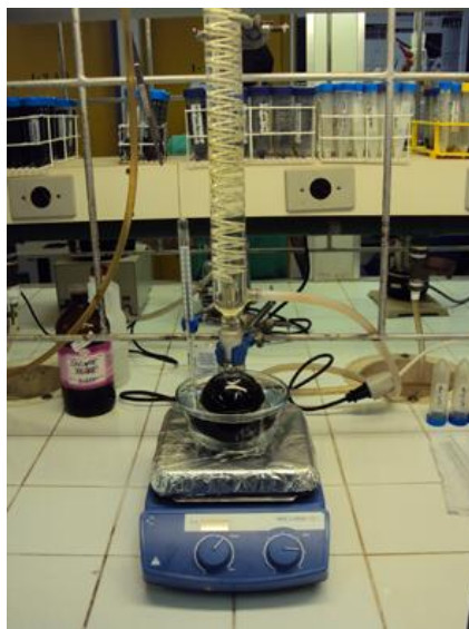
Figura 9. Fotografia do sistema de refluxo utilizado para a purificação dos nanotubos de carbono de parede múltiplas.
