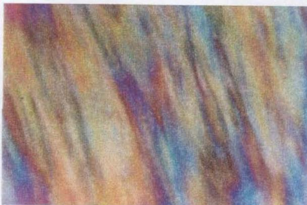
**Figura 3.3.2.1-2:** Textura característica de uma nemática calamítica. Amostra contendo frações mássicas de 0,37 de CTAB e 0,012 de Si. Aumento: 40X, temperatura 27°C.
