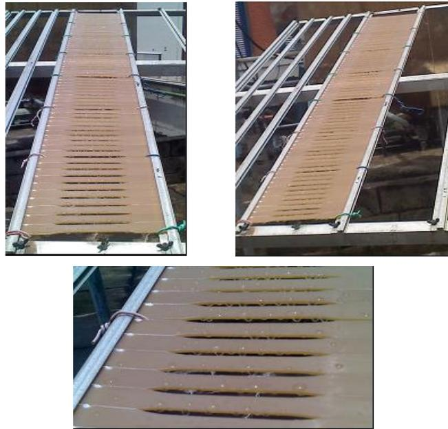
Figura 10: Corpos de prova posicionados no painel de exposição da Unicamp.
