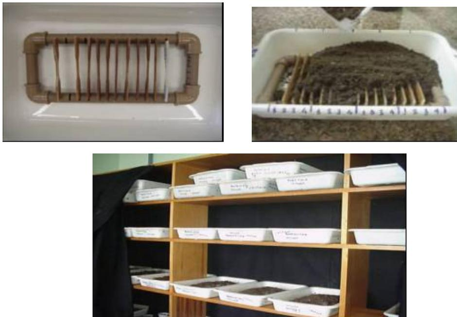
Figura 9: Corpos de prova enterrados em bandejas contendo solo simulado acomodadas em prateleiras sem luz.
