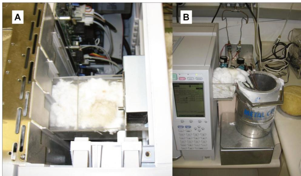
**Figura 20.** Foto do equipamento GC-qMS QP2010 Plus após conversão para GC×GC-qMS. A. Isolamento dos tubos do modulador com lã de vidro e guia de acrílico. B. Interface GC×GC mostrando o sistema de resfriamento dos gases de  $\text{N}_2$ , e ao fundo as válvulas solenóides e controladores de pressão.
