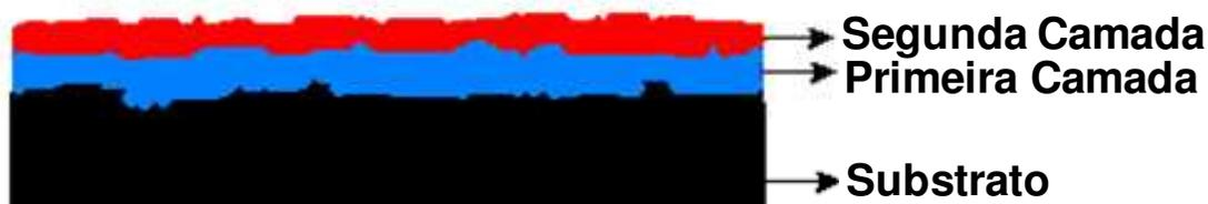
**Figura 93.** Modelo da formação de filmes finos bicamadas de diferentes óxidos. A primeira camada (em azul) representa a deposição do primeiro óxido e a segunda camada (em vermelho) representa a deposição do segundo óxido.
