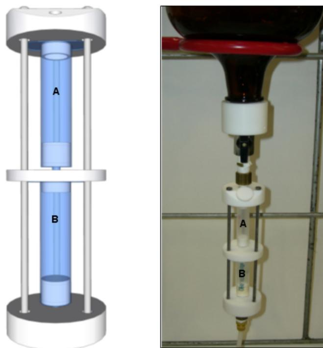
**Figura 13** – Esquema da montagem dos cartuchos de SPE e fotografia do sistema montado. A – cartucho de troca aniônica. B – Cartucho polimérico.
